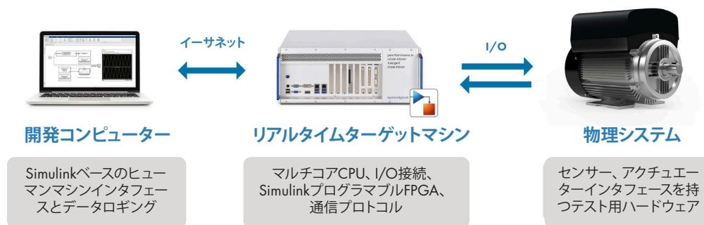
Simulink Real-Time を使用した典型的なリアルタイム シミュレーションおよびテストの環境 (写真提供 Speedgoat)
